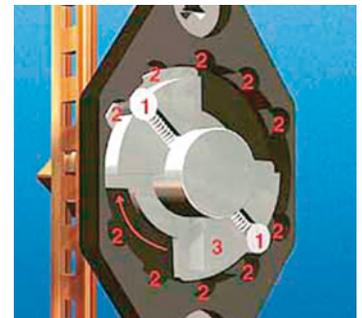
En poursuivant le mouvement de rotation, les goupilles de sécurité (1) sont entraînées par l'élément coupleur (3) vers d'autres évidements (2) dans lesquels elles s'engagent à nouveau en émettant un cliquetis parfaitement audible.
