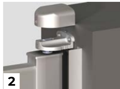
2 Gond haut caréné axe inox Ø16 mm laqué à la couleur du portail avec profil d'occultation laqué à la couleur du portail.
