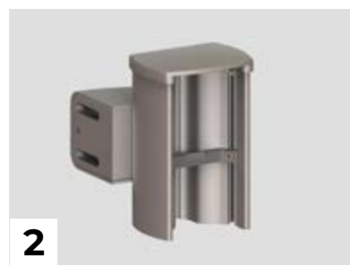
2 Profil de réception avec embout de finition. Gâche inox si serrure : L.94.3 x P.65.5 mm Équerre de fixation avec carénage
